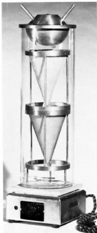
شکل ۲- تجهیزات استخراج (آزمون ب)
